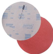
Lixamento de paredes na preparação para pintura e para o lixamento de madeiras. E utilizada na remoção de imperfeições e alinhamento da massa corrida, reduzindo as imperfeições e proporcionando um acabamento excelente no resultado final da pintura. Granas: 100", 120", 150", 180" e 220".
