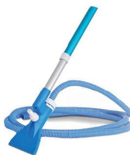
O Aspirador com Venturi é recomendado para a limpeza de pequenas piscinas, spas e ofurôs. Funciona através do engate de uma mangueira com água da rede. A pressãp promove um vácuo que suga a sujeira do fundo do tanque e é descartada para fora da piscina.
