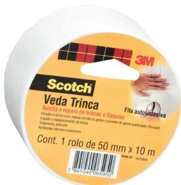
A Fita Veda Trinca 3M Scotch® auxilia no reparo de trincas e fissuras com menos de dois milímetros de profundidade, impedindo o reaparecimento da trinca. Flexível e fácil de ser aplicada, ela pode ser utilizada em paredes, forros com massa corrida ou gesso e paredes de gesso acartonado (drywall).
