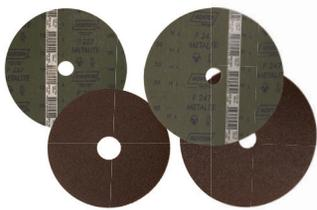
É um disco feito com grão Óxido de Alumínio Marrom, utilizado em operações de desbaste de tubos de PVC, lajota de ferro, materiais em aço, e remoção de tinta antiga e/ou oxidação leve. Tamanhos: 4.1/2" e 7". Granas: 24", 36", 50", 60", 80", 100" e 120".
