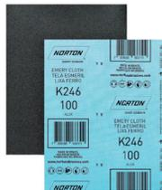
Pode ser aplicada tanto em lixamento manual quanto com máquinas portáteis. Para remoção de tintas, desbaste de massas plásticas (rápida e poliéster), preparação e nivelamento de superfícies. Granas: 36", 40", 50", 60", 80", 100", 120", 150", 180" e 220".
