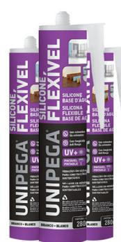
Selante flexível com fungicida, isento de solventes, recomendado para construções sustentáveis. Ideal para colagem e vedação em torno de esquadrias, rodapés, garnições, aplicações em juntas e acabamentos de móveis. Adere em madeira, MDF, compensado, concreto, gesso, drywall, pedra e alvenaria. Pode receber revestimento sobre a aplicação e pode ser pintado.
