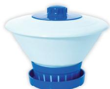
O clorador Margarida possui método de dosagem controlada através da abertura e fechamento das cavidades inferiores (para saber o quanto dosar é necessário consultar o fabricante do produto químico). Possui na parte inferior um prato que impede que pedaços da pastilha caiam no fundo da piscina.
