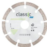
É indicado para operações que necessitam de cortes precisos, sendo ideal para realizar corte de concreto, tijolos, telhas e alvenaria, em alto rendimento. Uso em Serra Mármore. Corte úmido. 4 polegadas.
