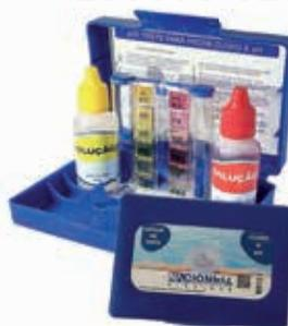
Kit de análise da água. Para testes níveis de PH e de Residual de Cloro.
