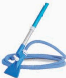
O Aspirador com Venturi é recomendado para a limpeza de pequenas piscinas, spas e ofurôs. Funciona através do engate de uma mangueira com água da rede. A pressãp promove um vácuo que suga a sujeira do fundo do tanque e é descartada para fora da piscina.
